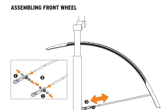
**ASSEMBLING AT SUNTOUR SUSPENSION FORK**
